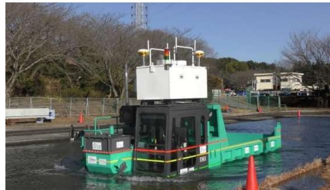
遠隔操縦による半水中走行実験
