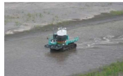
重運搬ロボット2号機(半水中走行)
