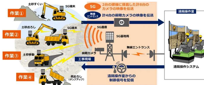
5Gを用いた重機の遠隔操縦試験の概要図（出典： https://www.obayashi.co.jp/technology/shoho/083/2019_083_33.pdf ）
