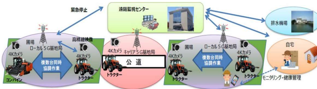
図2-16 ローカル5Gとパブリック5Gの準同期運用を含めた共用検討 (自動トラクター等の農機の遠隔監視制御による自動運転の実現)
