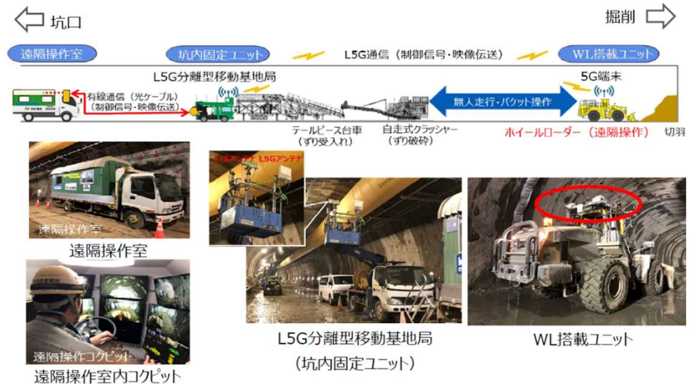
「ローカル5G通信を用いたホイールローダー遠隔操作システム」の技術の構成図 (出典: https://www.nishimatsu.co.jp/news/news.php?no=NDg4 )
