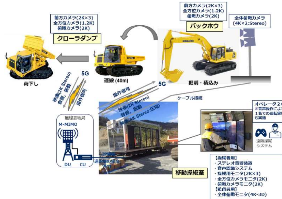
図2-4 室内試験で遅延80ms、現場簡易計測で遅延約100msを実現 (KDDI、(株)大林組、日本電気(株)／建機遠隔操縦への応用を想定する検討・評価)
